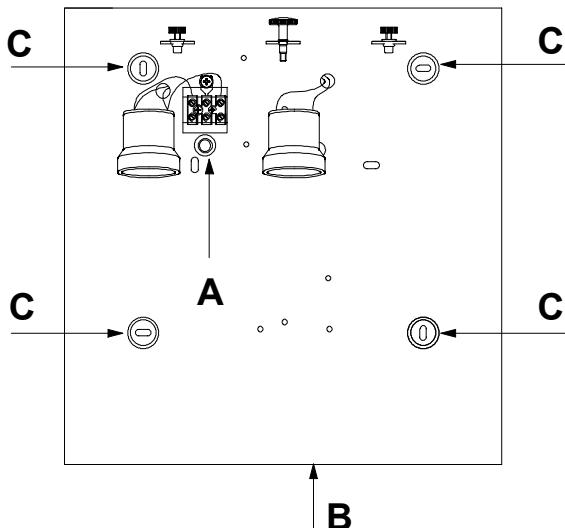
► Far passare i cavi elettrici provenienti dalla parete attraverso il foro **A** e fissare il fondello **B** alla parete mediante le asole **C**. Rimuovere il coprimorsetto. Eseguire i collegamenti elettrici all'apposito morsetto collegando il cavo di messa a terra al polo contrassegnato con  $\oplus$ . Rimontare il coprimorsetto.
