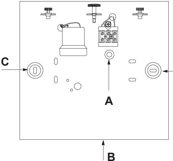
► Far passare i cavi elettrici provenienti dalla parete attraverso il foro **A** e fissare il fondello **B** alla parete mediante le asole **C**. Rimuovere il coprimosetto. Eseguire i collegamenti elettrici all'apposito morsetto collegando il cavo di messa a terra al polo contrassegnato con  $\oplus$ . Rimontare il coprimosetto.
