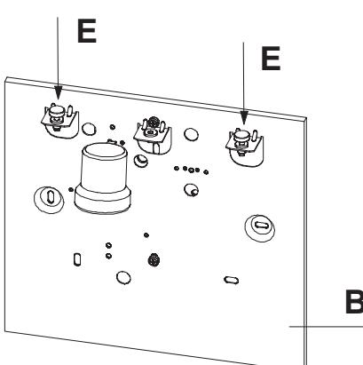
► Appoggiare il diffusore **D** sul fondello **B** e controllare la sua posizione. Nel caso fosse necessario regolare in orizzontale il suo orientamento, rimuoverlo dal fondello ed agire manualmente sulle due viti **E**, fino a raggiungere un corretto allineamento orizzontale. Eseguita questa operazione, inserire la lampadina. Posizionare il diffusore **D** sul fondello **B** ed avvitare la vite **F**.
